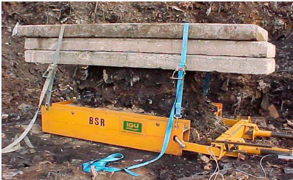
Bild 2: Probekörper mit aufgebrachtter Belastung
